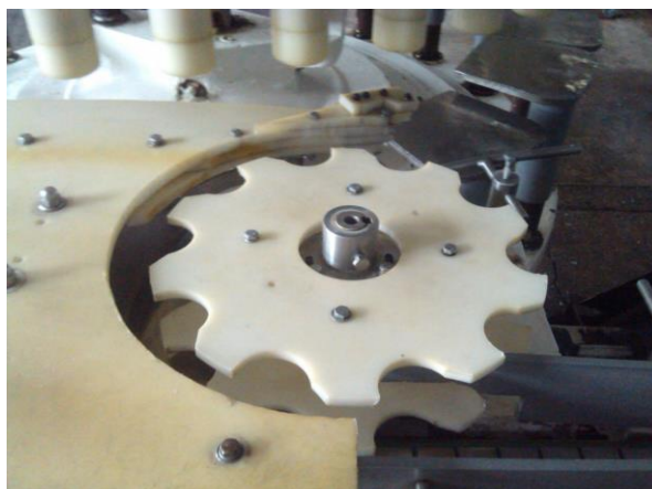
Figura 11. Estrella de salida de botellas de la llenadora rotativa de la línea de producción de salsa a base de tomate y ketchup de la empresa Alimentos Garmi C.A.
