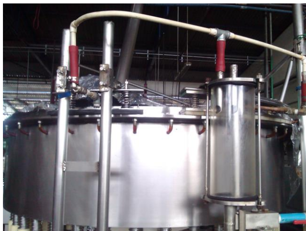
Figura 6. Sistema de succión de vacío de la llenadora rotativa de la línea de producción de salsa a base de tomate y ketchup de la empresa Alimentos Garma C.A.
