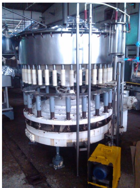
Figura 3. Llenadora rotativa de la línea de producción de salsa a base de tomate y ketchup de la empresa Alimentos Garmi C.A.
