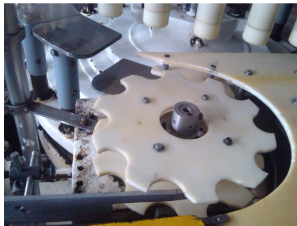
Figura 8. Estrella de entrada de botellas de la llenadora rotativa de la línea de producción de salsa a base de tomate y ketchup de la empresa Alimentos Garmi C.A.
