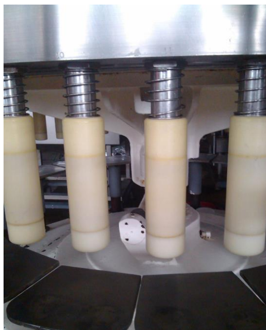
Figura 10. Picos de llenado de la llenadora rotativa de la línea de producción de salsa a base de tomate y ketchup de la empresa Alimentos Garmi C.A.
