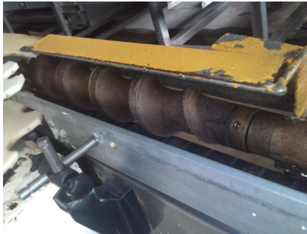
Figura 7. Tornillo sinfín de entrada de botellas de la llenadora rotativa de la línea de producción de salsa a base de tomate y ketchup de la empresa Alimentos Garmi C.A.
