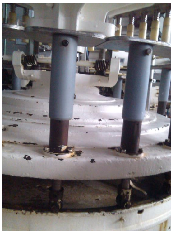
Figura 9. Gato mecánico elevador de botellas de la llenadora rotativa de la línea de producción de salsa a base de tomate y ketchup de la empresa Alimentos Garimi C.A.
