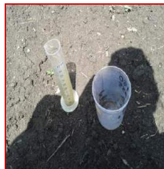
Figura 48. Medición de la lámina de agua captada por el pluviómetro.
