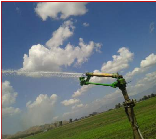
Figura 42. Vista del aspersor empleado en las parcelas evaluadas con riego por aspersión.
