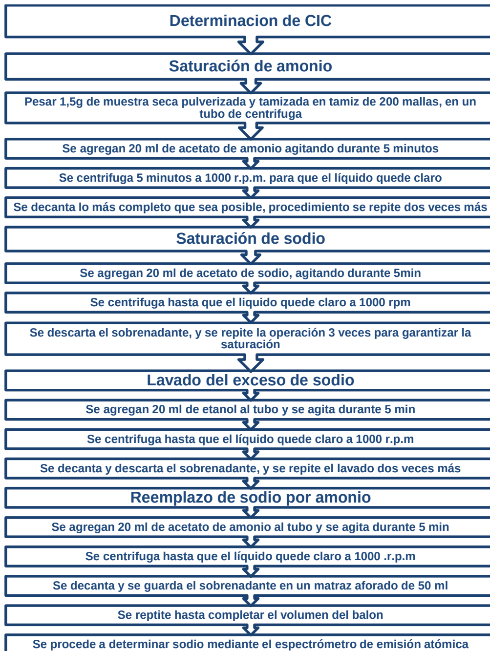
Figura 13. Esquema experimental para la determinación de CIC.
