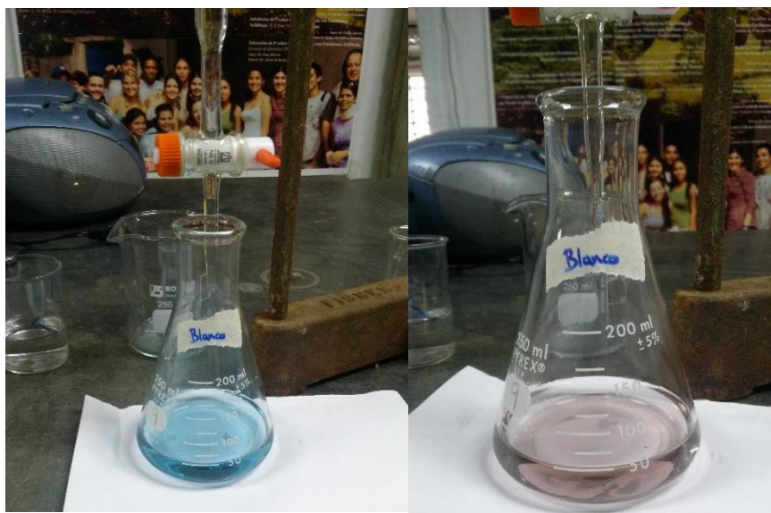
Figura 15. Titulación ácido-base para la determinación de %N.
