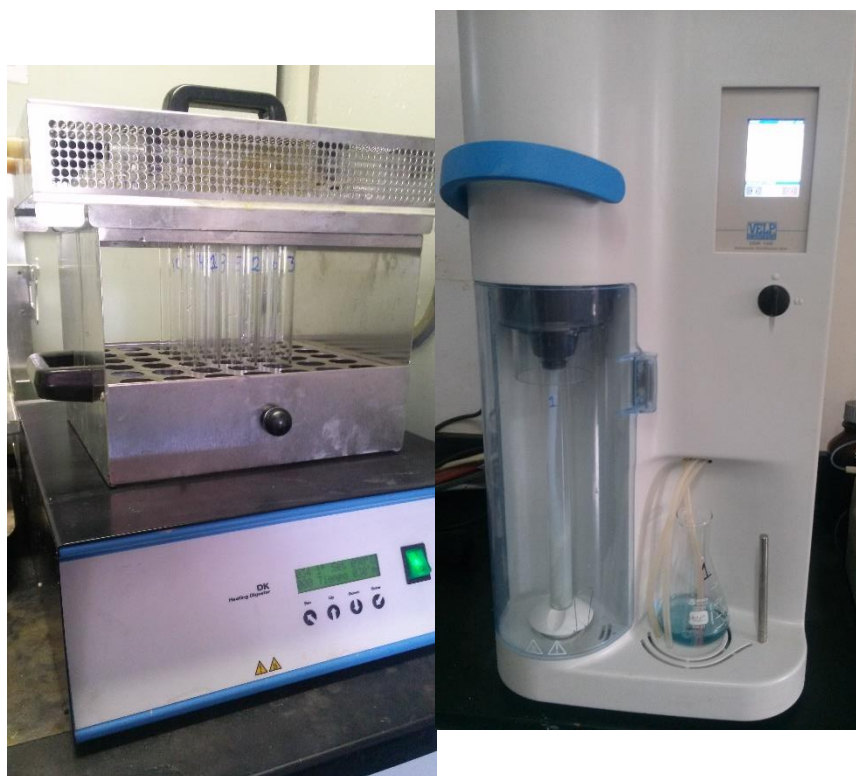
Figura 14. Equipo digestor y destilador VELP utilizado para el tratamiento de las muestras de sustrato.
