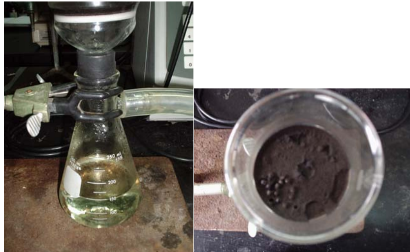
Figura 24. Filtración al vacío de la muestra de los huesos de ganado bovino calcinada a 500 °C, durante 2 horas e impregnada durante 1 hora. Sin activación.
