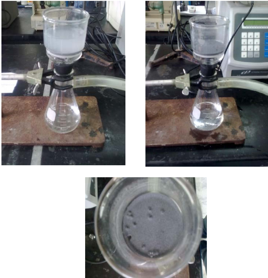
Figura 21. Filtración al vacío de la muestra de los huesos de aves calcinada a 700 °C, durante 2 horas e impregnada durante 1 hora. Sin activación.
