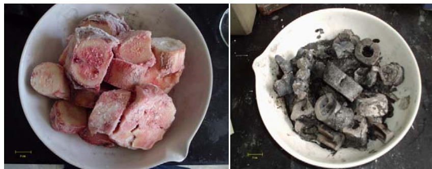
Anexo 7. Huesos de Ganado Bovino antes y después de la calcinación a 500 °C por 2 Horas
