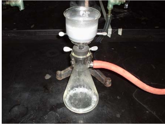
Anexo 4. Montaje para realizar las filtraciones luego de las impregnaciones y los lavados.
