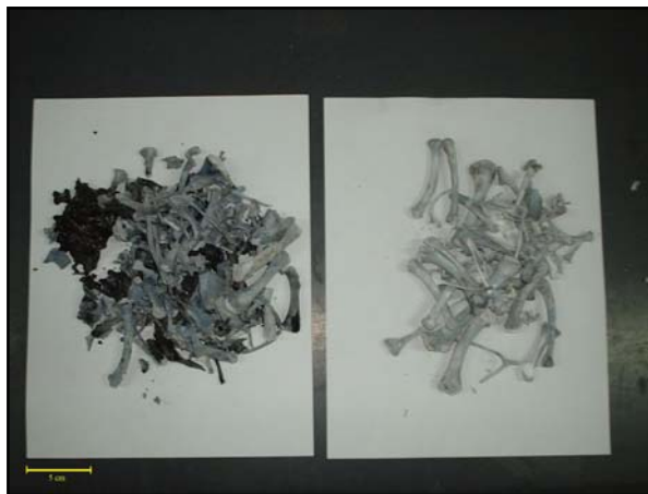
Figura 20. Muestras de huesos de aves calcinados a 600 °C y 700 °C durante 3 horas.
