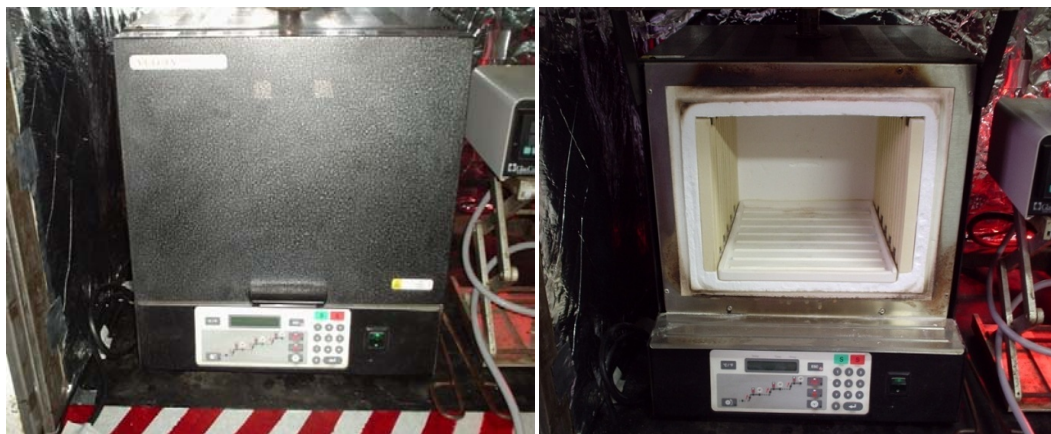
Anexo 1. Mufla usada en los experimentos para la calcinación y la activación
