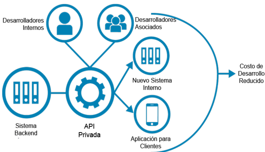
Figura 6.2: Estructura e Interacción de un Web API Privado
