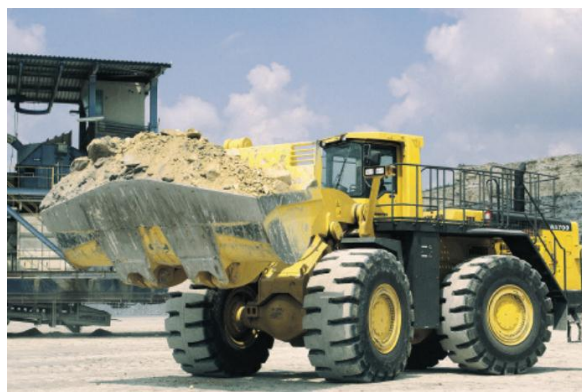
Fig. 4 Cargador frontal Komatsu WA700-3
