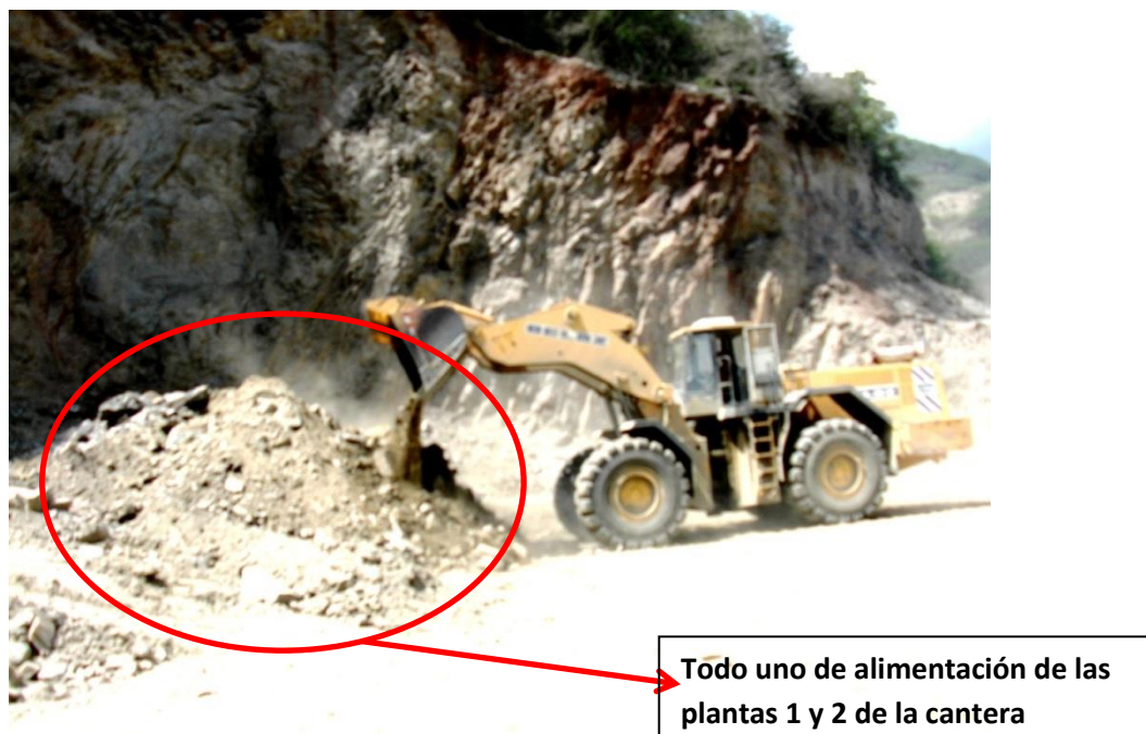
Figura N° 12. Todo-uno de alimentación de las plantas 1 y 2 de la cantera Carayaca.
