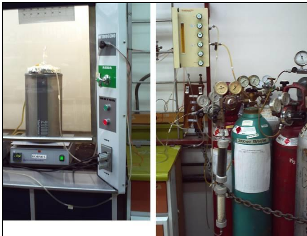
Figura 36.- Sistema de Reacción a Temperatura Programada.
