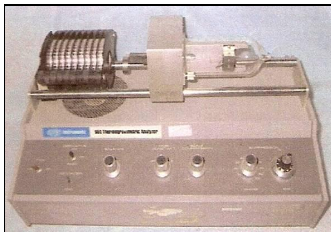
Figura 39.- Equipo empleado para el análisis de TGA.
