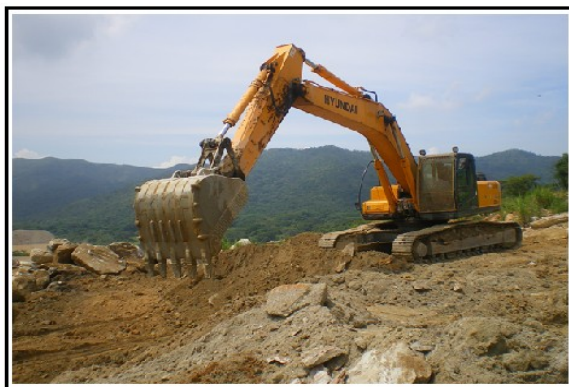
Figura N° 19. Excavadoras sobre orugas marca Hyundai modelo 320LC7. Fuente: Propia
