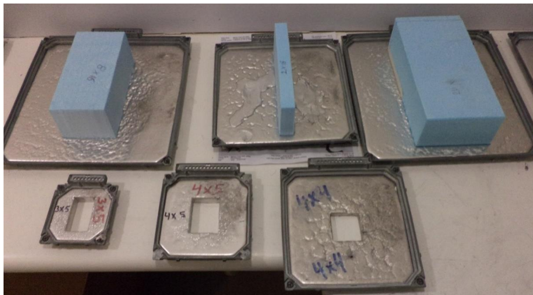
Figura 4. 7. Insertos de diferentes tamaños rectangulares para simular casos clínicos.
