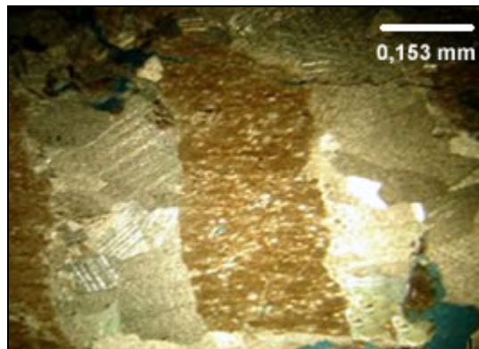
Figura 23.- Cemento equigranular dentro de fracturas, evidencia de diagénesis temprana.
