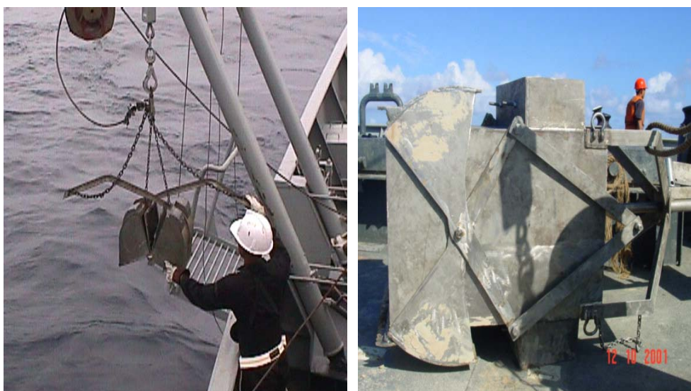
Figura 5.3.- Fotografías de la draga mecánica empleada para la toma de muestras de sedimentos marinos superficiales.
