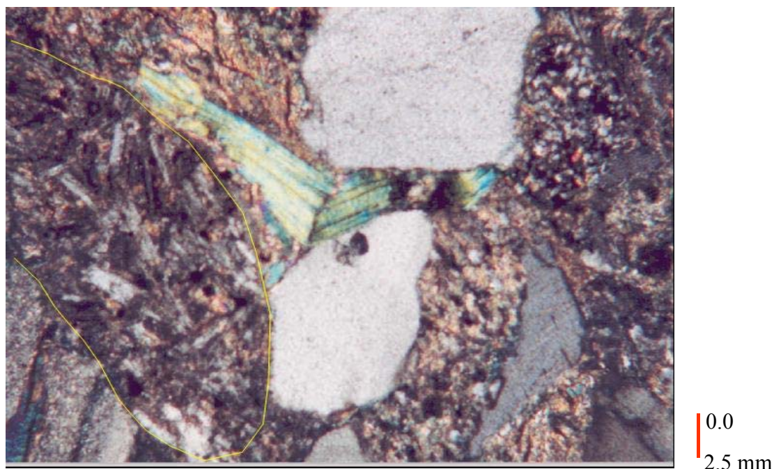
Figura 4.3. Fragmento de roca volcánica en una arenisca de la Formación Río Negro. Pozo VLA722 (14552')
