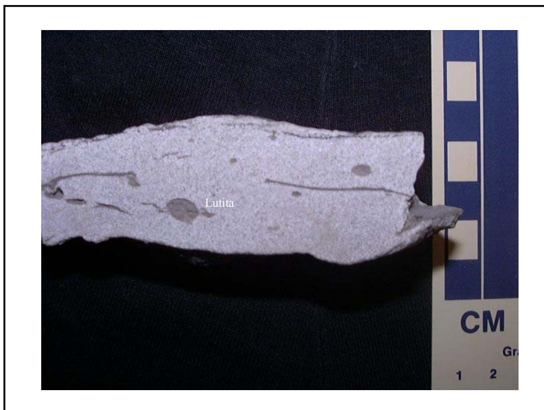
Figura 6.31. Arenisca calcárea asociada a ambientes de bahías interdistributarias, con clastos y hojuelas de arcilla. Pozo LL3045 (6209').
