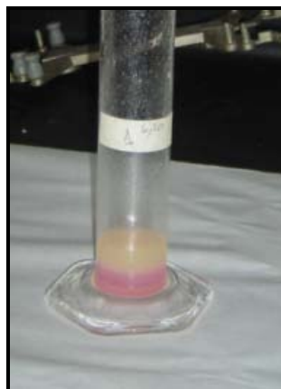
FIGURA 21 Muestras titulada, (a) Antes de su titulación, (b) después de su titulación, en su punto de equivalencia.
