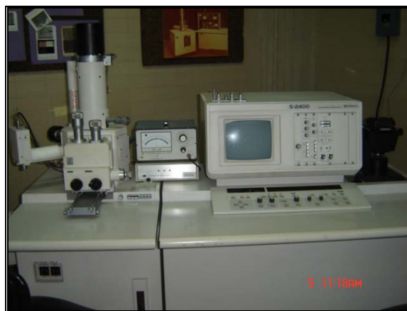
FIGURA 18 Evaporador de alto vacío modelo HITACHI HUS-56B (a), Mentalizador modelo HITACHI E-102 SPHER (b), Microscopio electrónico de barrido modelo S-400 (c).
