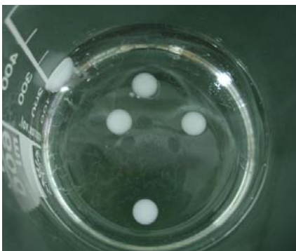
Figura 20: Determinación del tipo de emulsión, gotas de emulsión en agua
