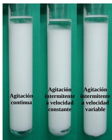
Figura 42: Emulsiones obtenidas a partir de diferentes tipos de agitación a los 30 días de la preparación
