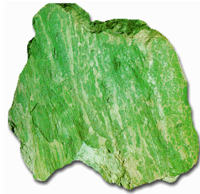
Figura 2. La Garnierita (Ni, Mg)_6[(OH)_8/Si_4O_{10}] , es una de las fuentes minerales más empleados en la extracción de este metal. 3b
