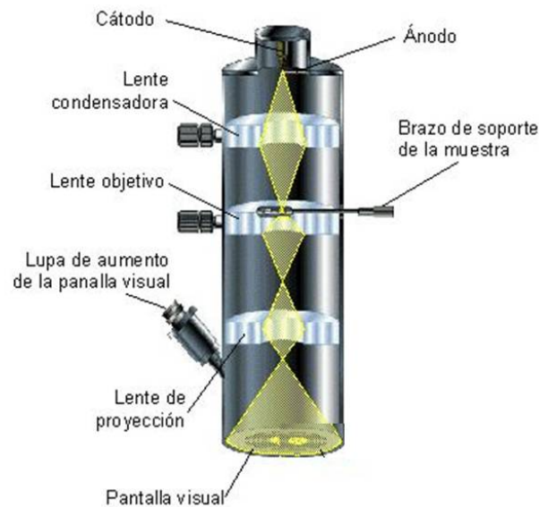
Figura 1.20: Esquema de un Microscopio Electrónico de Transmisión [16]
