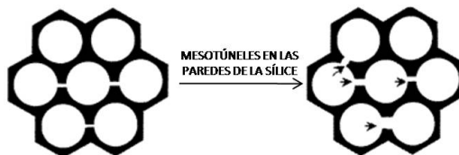
Figura 1.8: Ordenamiento hexagonal de los poros y porosidad complementaria [7]
