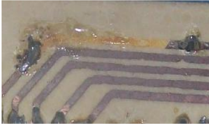
Fig. 60 Daño en el circuito impreso.
