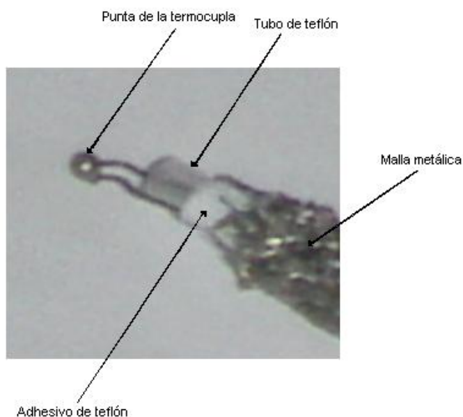
Fig. 58 Detalle de la punta de la termocupla mostrando las distintas cubiertas.
