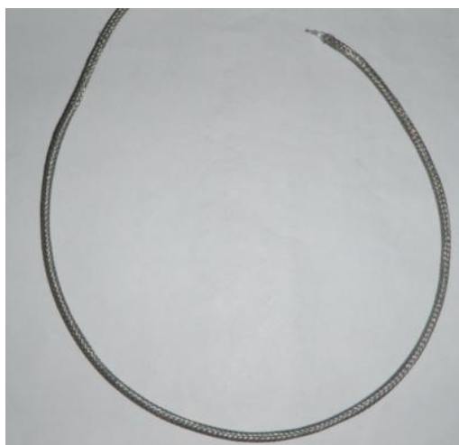
Fig. 59 Termocupla cubierta con la malla metálica
