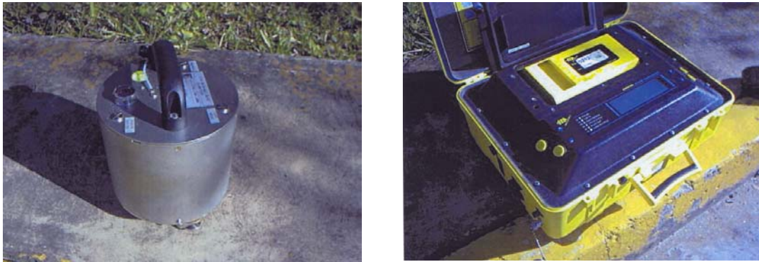
Figura 3.3. Equipo utilizado en la adquisición de ruido ambiental. Izq: Sensor. Der: Orion
