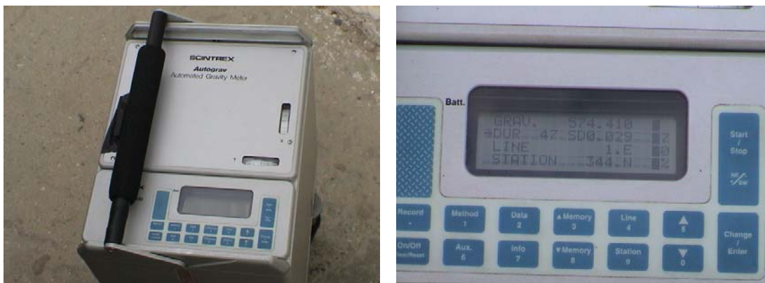
Figura 3.1. Equipo Scintrex Autograv CG-3 propiedad de la Armada Nacional utilizado para la adquisición de los datos gravimétricos.
