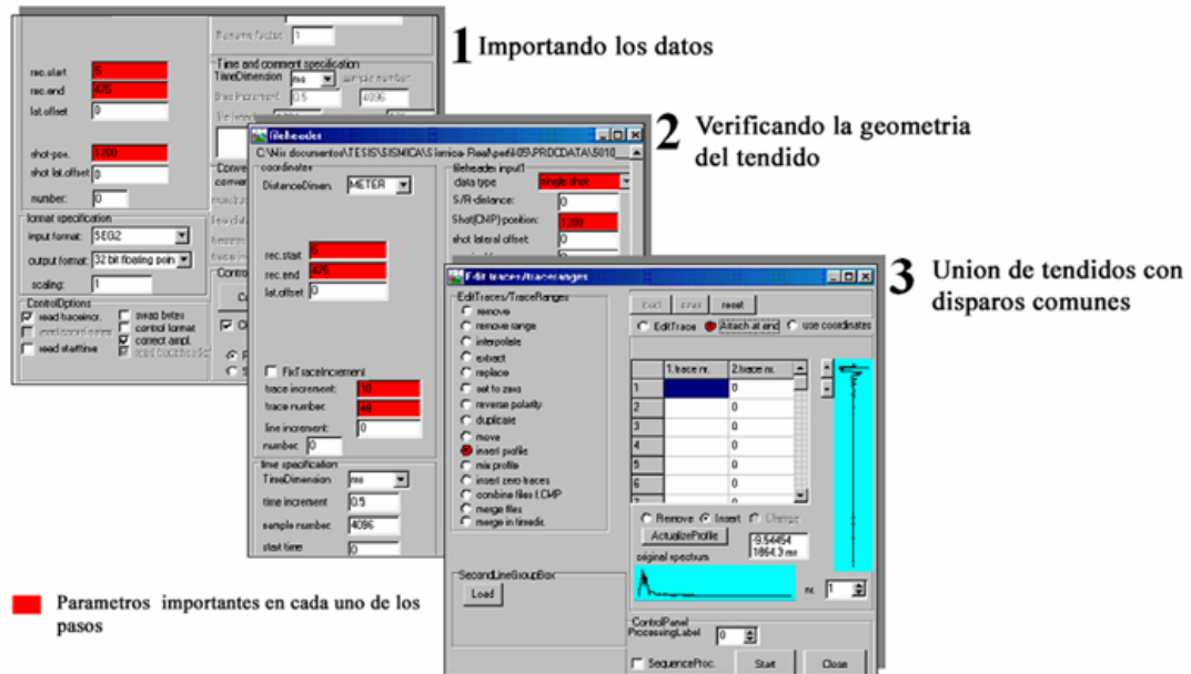
Figura 3.7. Esquema representativo de parte del procesamiento sísmico con el programa REFLEX.
