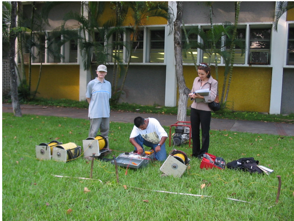
Figura 4.14. Disposición Schlumberger para ambos equipos
