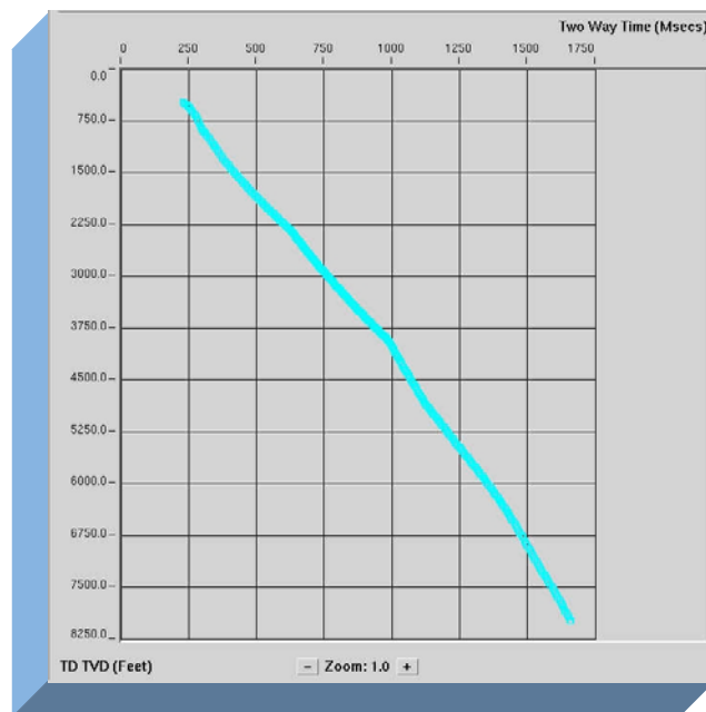
Figura 5.4. Curva de velocidad del pozo 4.
