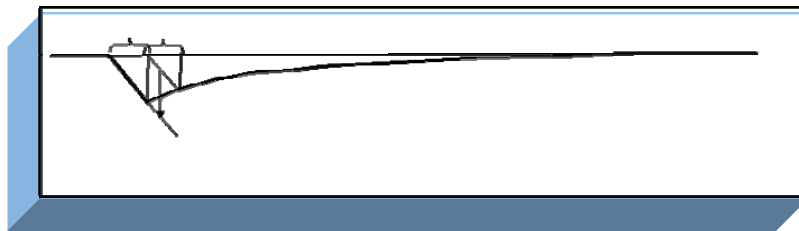
Figura 3.9 Construcción chevron , paso 2 (Geos-PDVSA, 2004).
