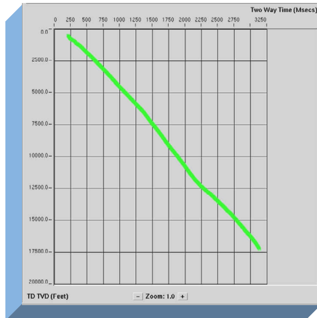
Figura 5.14. Curva de velocidad del pozo 14.
