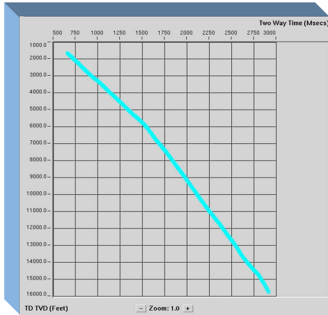
Figura 5.2. Curva de velocidad del pozo 2.
