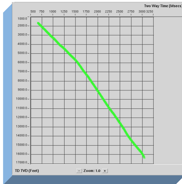
Figura 5.15. Curva de velocidad del pozo 15.
