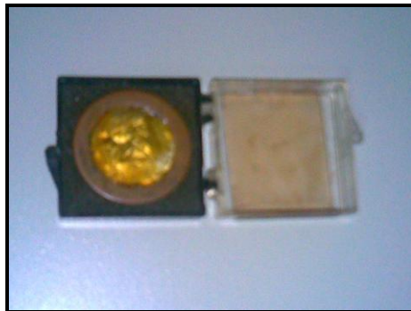
Figura 4.7. Muestra de Calibración del equipo Mössbauer compuesta por Hierro Metálico
