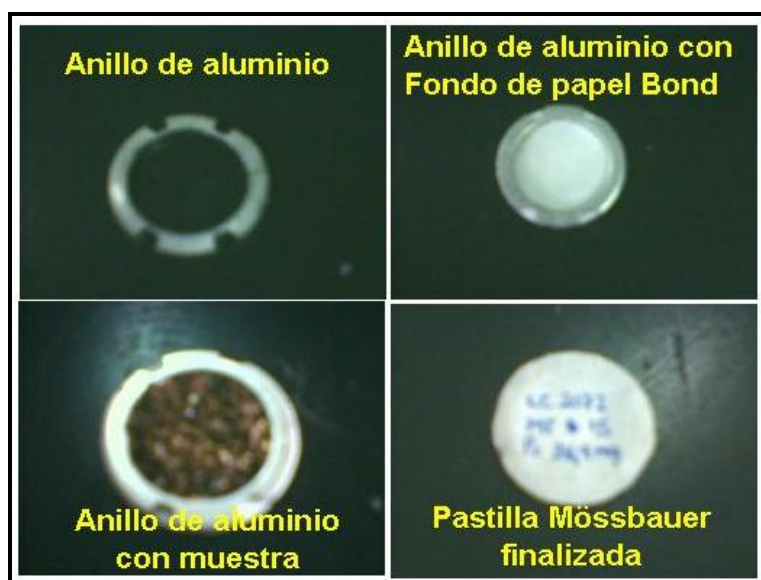
Figura 4.9. Proceso de Preparación de la muestra a aplicarle el Método de Espectroscopia Mössbauer a temperatura ambiente.
