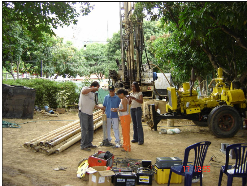
Figura 7. Equipo de adquisición sísmica de pozos en el sector Los Chorros. Al pie de la foto: el instrumental. A la derecha: la fuente. Al fondo: Equipo de perforación de pozos.
