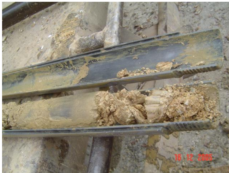
Figura 36. Muestra de arena recuperada con la cuchara partida (Pozo P-2, La Carlota).
