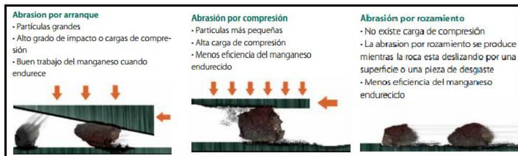
Figura 11. Mecanismos de abrasión, compresión e impacto para la fractura de Rocas. Fuente: Guía de aplicación de piezas de desgaste (Metso 2012)
