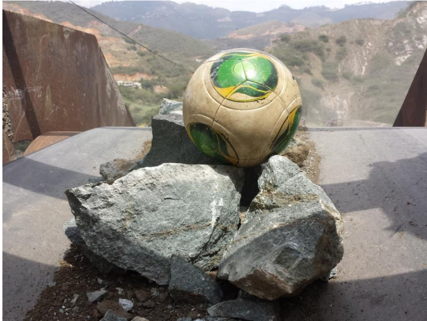
Figura 33. Productos de la trituración Primaria
