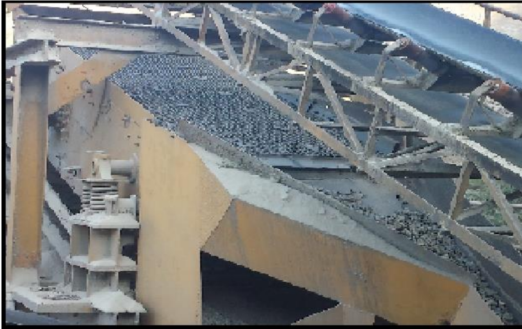
Figura 27. Criba Vibratoria de 2 mallas (1 1/4" y 3/8")
