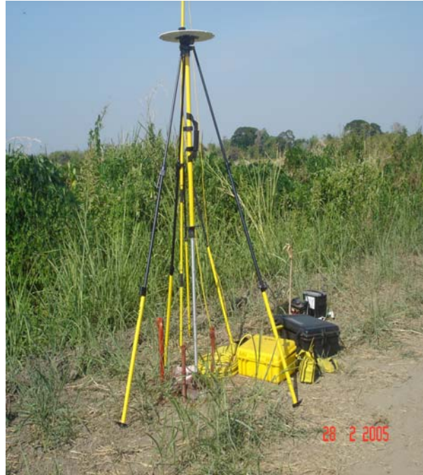
Figura 41 Imágenes de posicionador Satelital Diferencial (GPSD) marca TRIMBLE modelo 4700.
