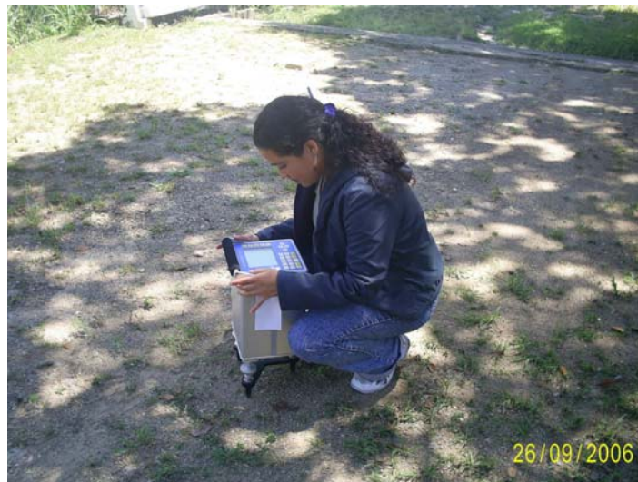
Figura 43 Calibración del gravímetro Autograv Scintrex CG-5.
