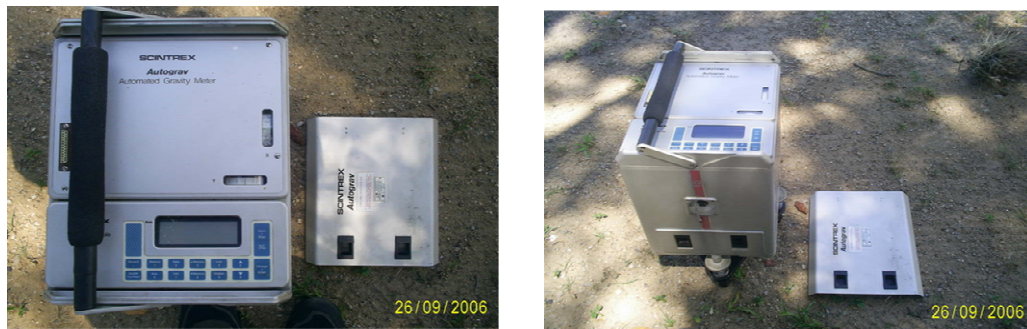
Figura 39. Imagen de Gravímetro AUTOGRAV Scintrex CG-3 Izquierda: vista superior. Derecha: vista lateral.
