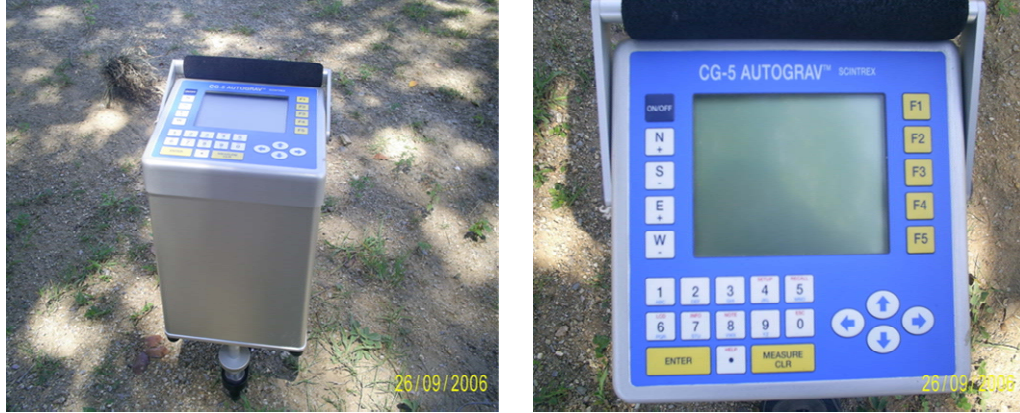
Figura 40 Imagen de Gravímetro AUTOGRAV Scintrex CG-5. Izquierda: vista lateral. Derecha: vista superior.
