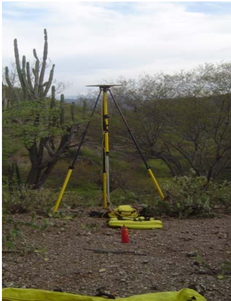
Figura 46 Posicionador Satelital Diferencial (GPSD) marca TRIMBLE modelo 4700.
