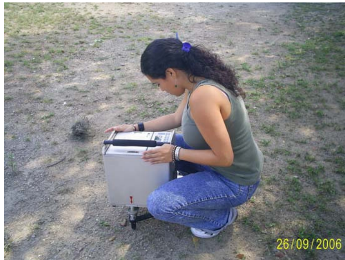
Figura. 34 Calibración del gravímetro Autograv Scintrex CG-3
