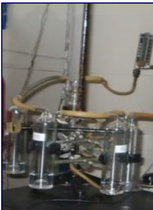
Figura 7. Sistema de purificación del gas inerte ( \text{N}_2 ). 60
