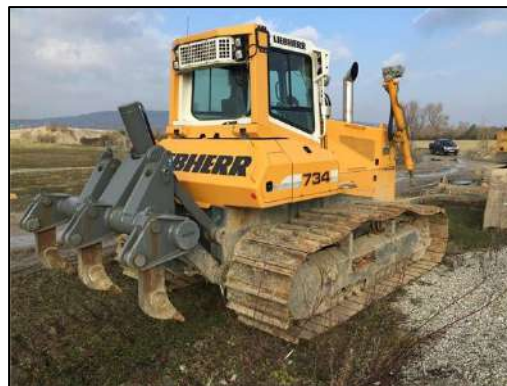
Figura 5.16 Tractor con ripper trasero de 3 puntas. Fuente: Liebherr.com
