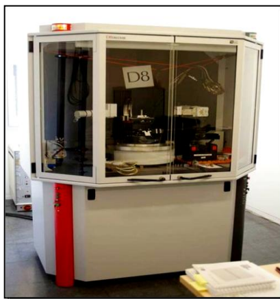
Figura 13.- Difractómetro de rayos X marca Bruker AXS modelo D-8 Discover.
