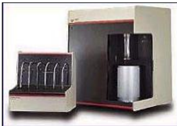
Figura 14.- Equipo de adsorción y desorción de nitrógeno Micromeritics Tristar 3000.
