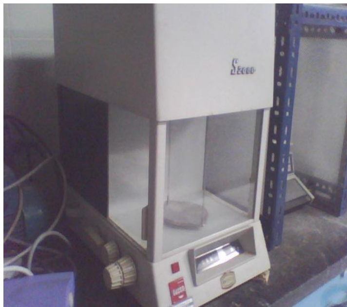
Figura 16. Balanza modelo S-2000. Marca: BOSH Merck Cofasa S.A. \pm 0.0001\text{g} .
