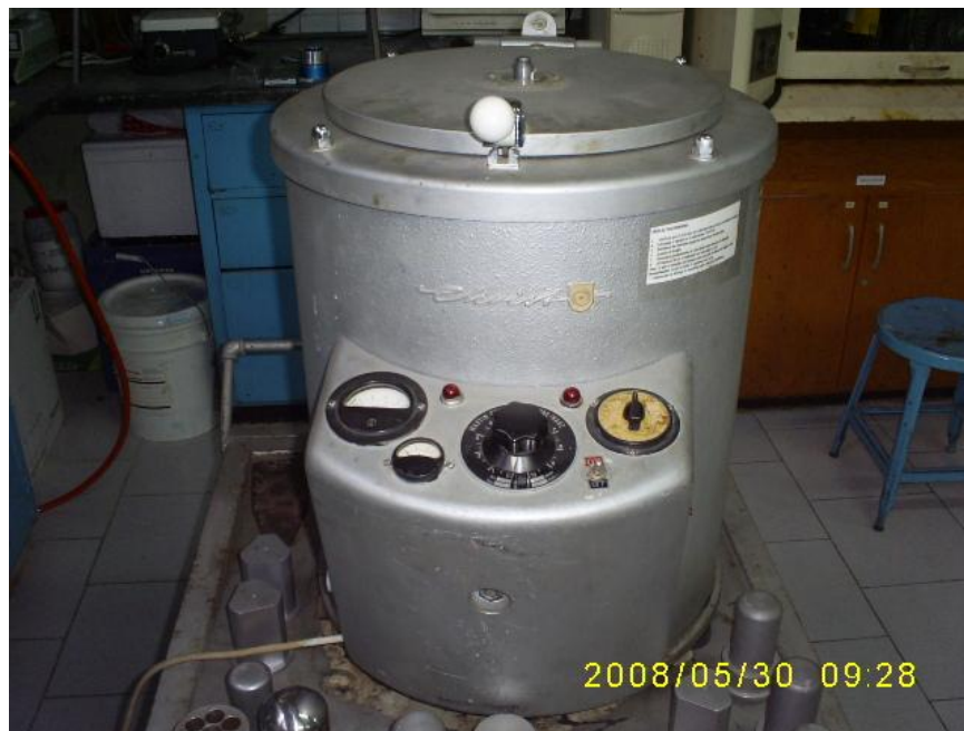
Figura 11. Equipo centrífuga. Modelo EHNISA. 330 Watt y 220 V. Max. rpm 10000.
