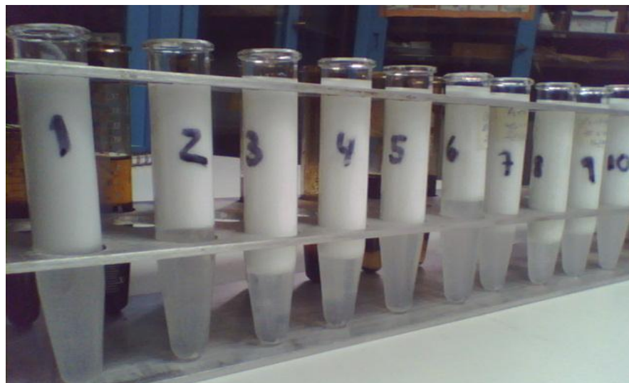
Figura 10. Tubos de centrifugas graduados de capacidad, 15 mL c/u, con la muestra sintética, después del proceso de centrifugación.
