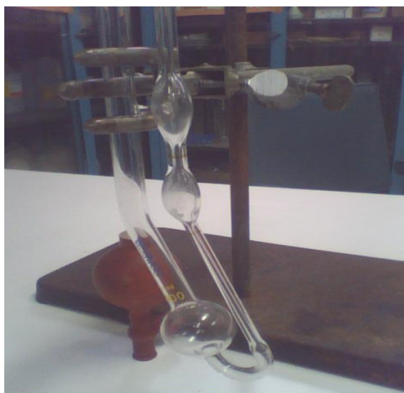
Figura 14. Viscosímetro Cannon-Fenske. Serie: 400. No.3188. Constante a 40°C: 1.1727. Constante a 100°C: 1.1681 Cst/s. Incertidumbre: +/- 0.5 %.
