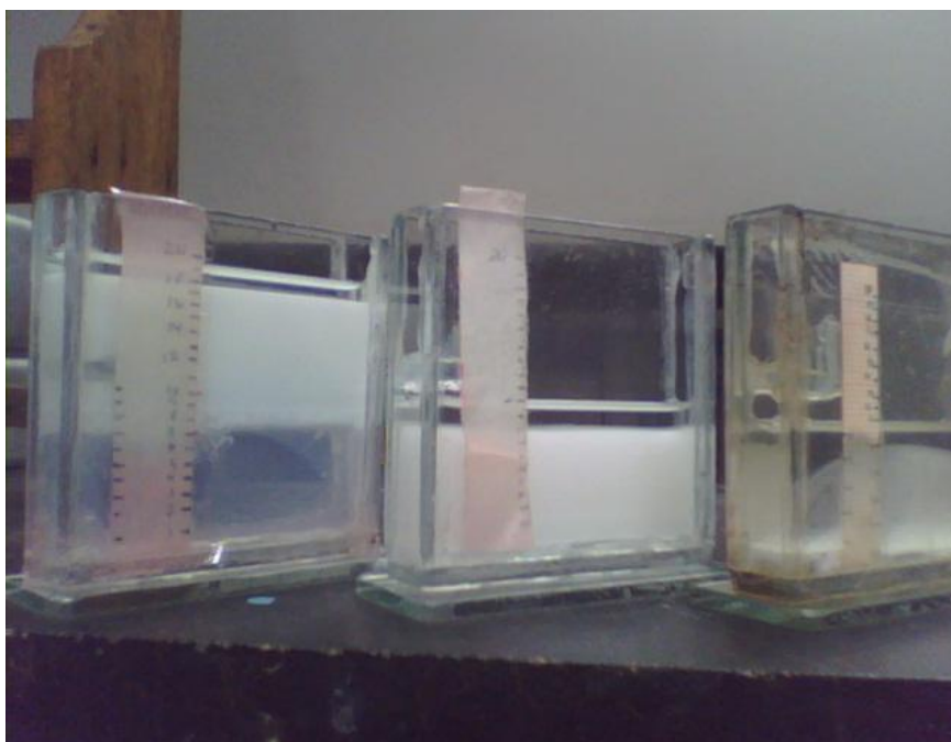
Figura 8. Celdas. Izquierda: muestra sintética separada por acción del campo eléctrico DC; fase inferior la coalescida y la superior emulsión sintética con líquido de consistencia oleosa. Intermedia: Celda electrostática con la fase intermedia constituida por la emulsión sintética y la fase líquida oleosa y la última, derecha: celda electrostática con la emulsión sintética retratada con el campo eléctrico D.C.
