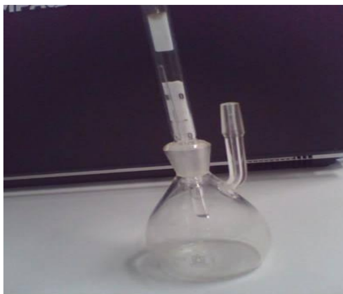
Figura 15. Pícnómetro modelo DIN/in Brand Duran. W. Germany. Capacidad 50.629 cm 3 con termómetro incorporado.
