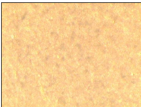
F.21.1. Emulsión sintética antes del campo eléctrico D.C. Objetivo 5X Aumento= 50X. T estabilidad = 2h
