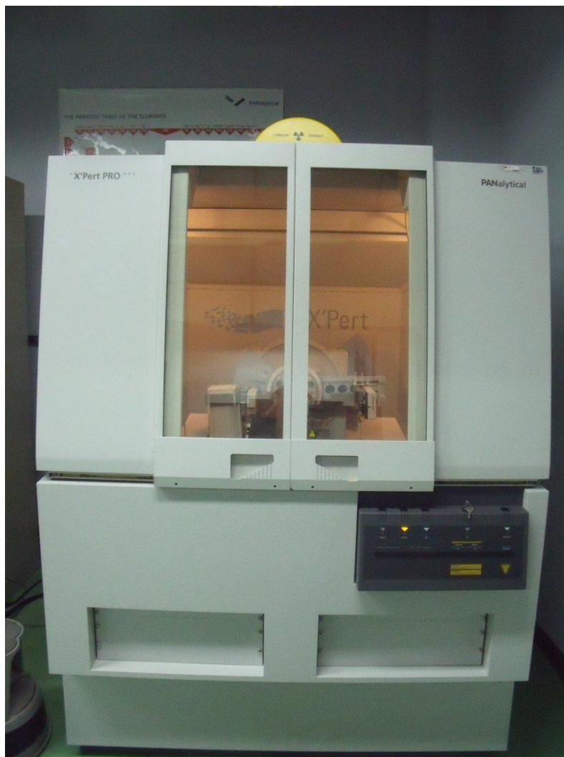
Figura 33: Difractómetro Xpert Pro marca Phillips.
