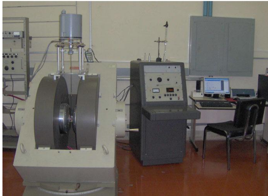
Figura 35: Equipo de Magnetometría de muestra vibrante
