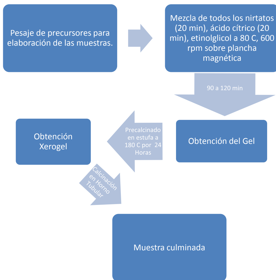
Figura 32: Esquema para la síntesis de las muestras
