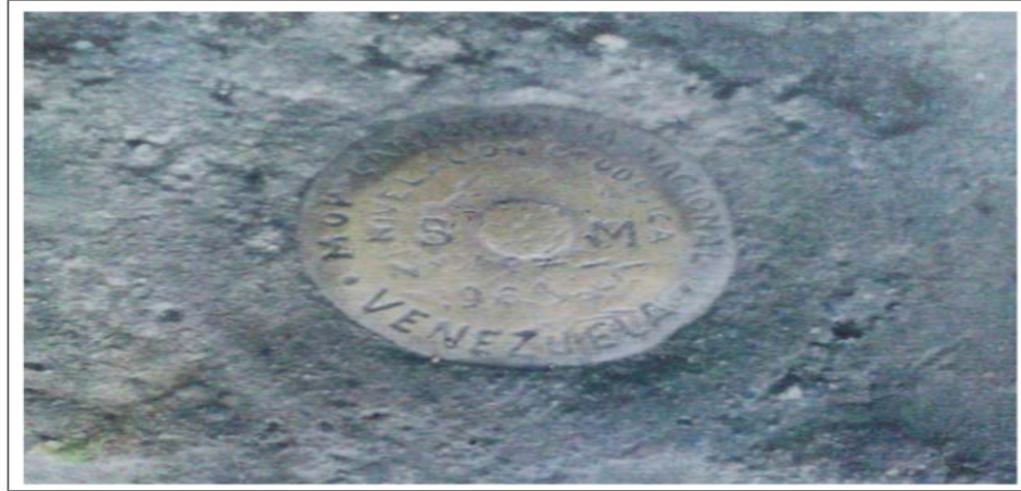
Figura N° 20. Origen de cotas B.M. C.A. P. -7 (Cartografía Nacional). Fuente: foto propia
