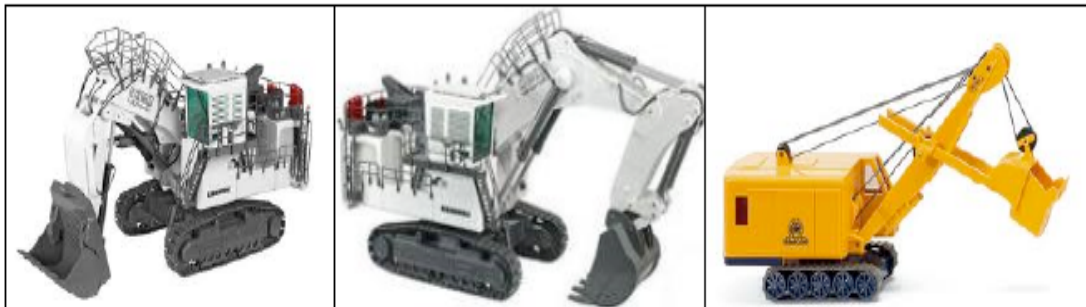
Figura N° 08. Excavadora frontal, excavadora y pala de cable. Tomado de: Navas, J. (2012).
