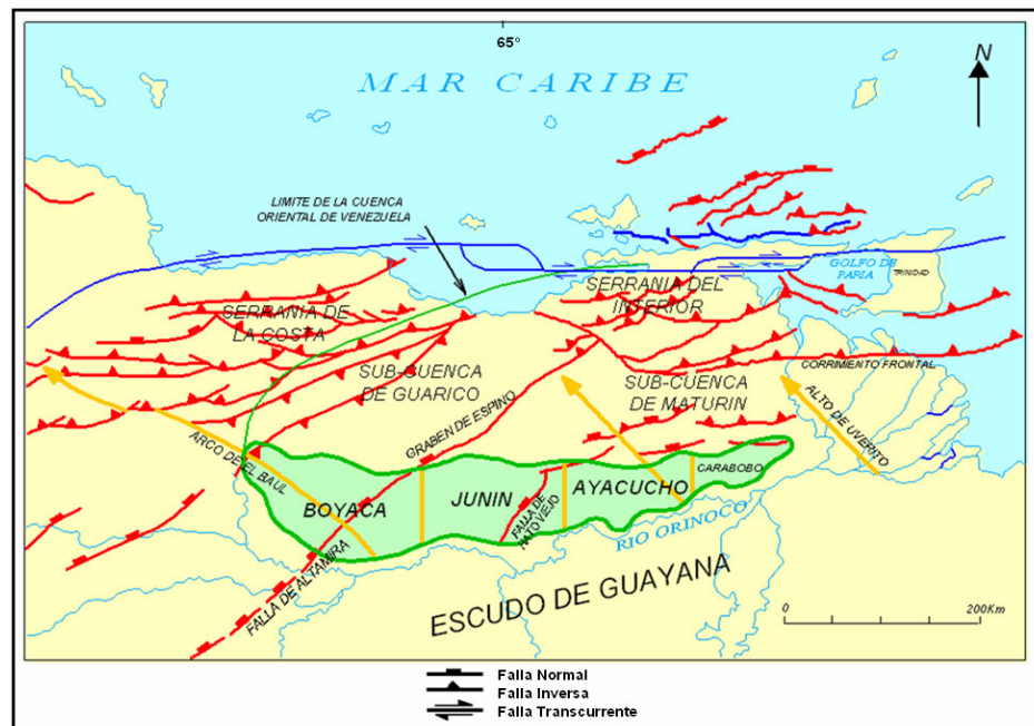
Figura 2.3. Rasgos estructurales de la Faja Petrolífera del Orinoco. Nótese como el sistema de fallas de Hato Viejo divide a la zona en dos provincias. Tomado de Castillo (2007).
