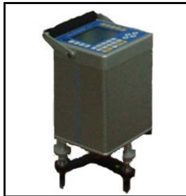
Figura 3.1. Gravímetro Digital SCINTREX AUTOGRAV CG-5 . (Tomado de Reinoza, 2006)
