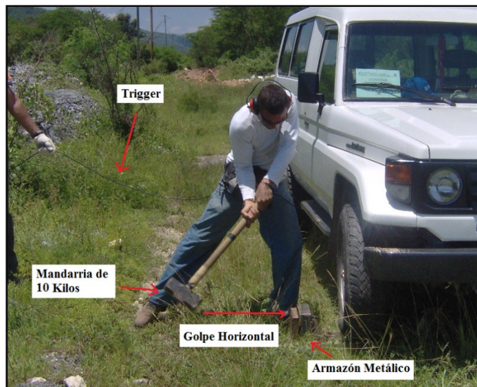
Figura 3.14: Configuración de la adquisición, método sísmico de refracción somera para el estudio de ondas S.
