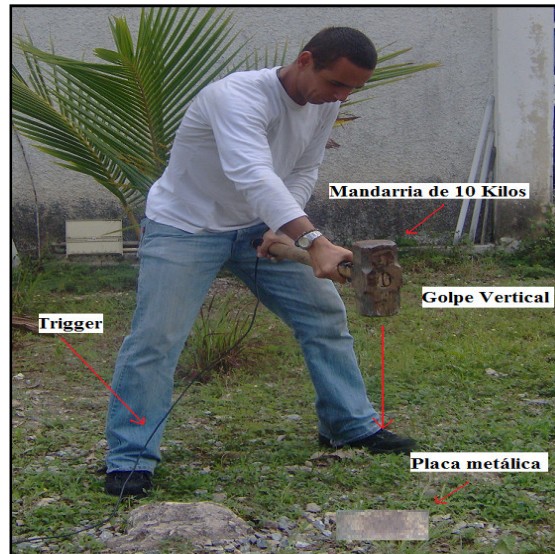
Figura 3.13: Configuración de la adquisición, método sísmico de refracción somera para el estudio de ondas P.
