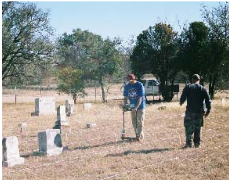
Figura 5: Medición de resistividades (fuente: Simpson y Peterson, 2004)
