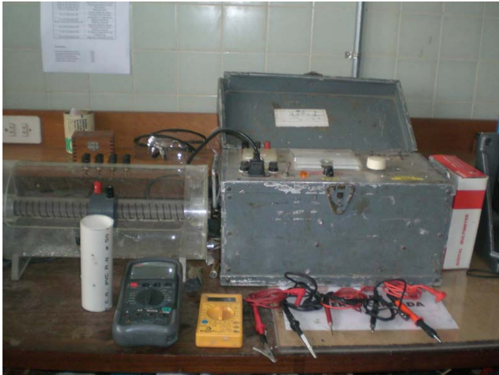
Figura 22: Equipo usado durante la medición de resistividades en laboratorio
