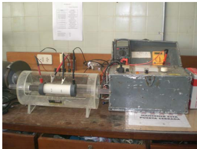
Figura 24: Medición de resistividades
