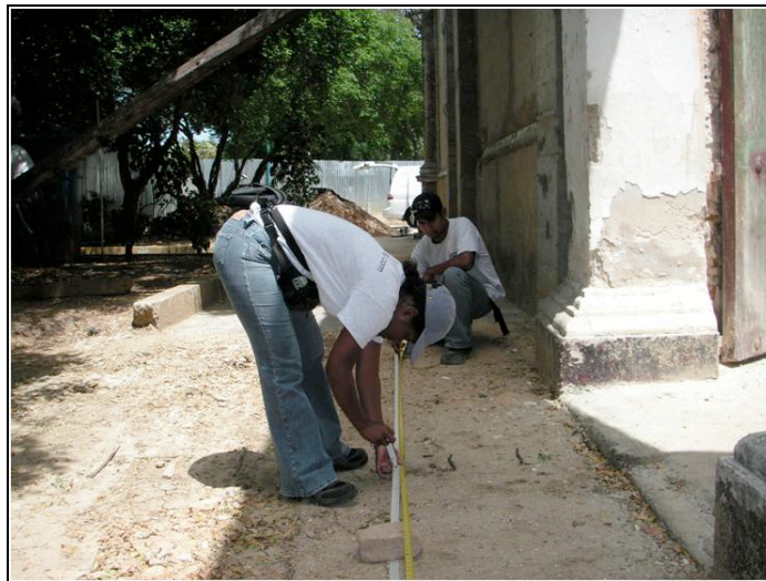
Figura 29. Colocación de marcas en la superficie para definir el mallado.
