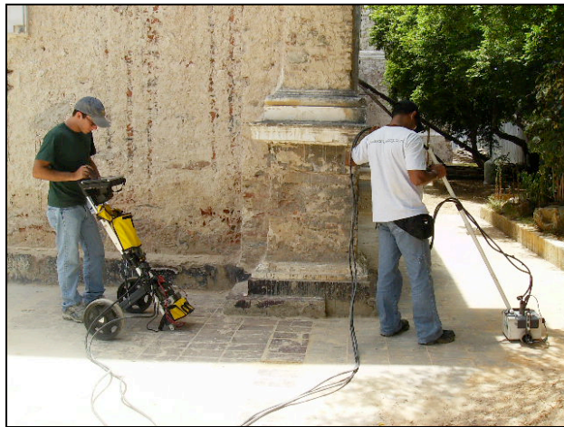
Figura 30. Adquisición de datos con GPR.
