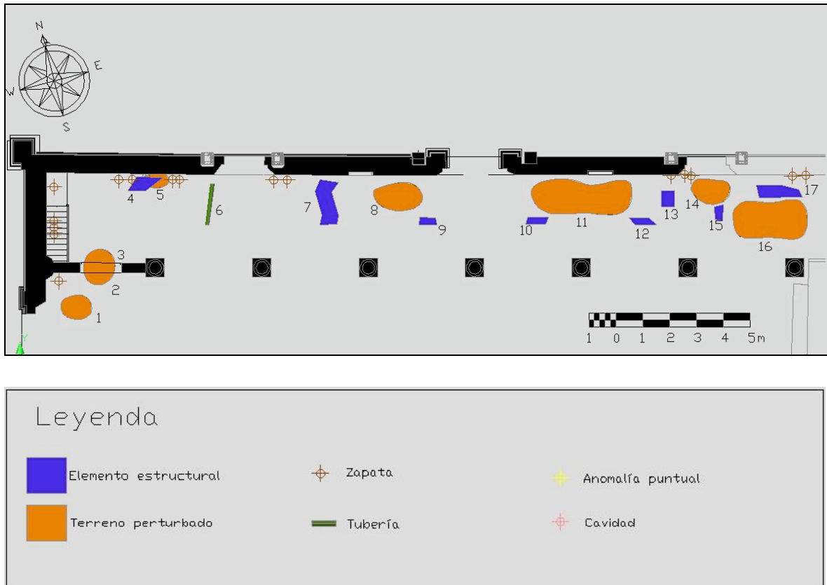
Figura 57. Anomalías en la zona norte del interior de la iglesia (área 2A).
