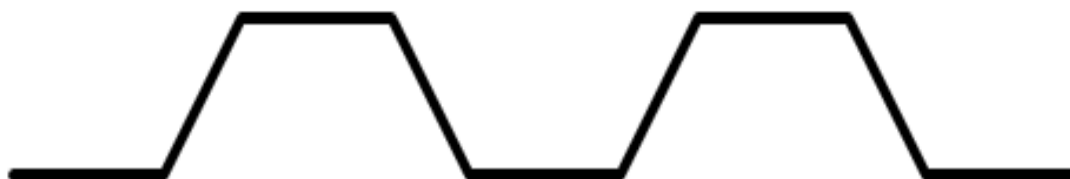
Figura 2.11 Excesivo tiempo de apertura del controlador de superficie
