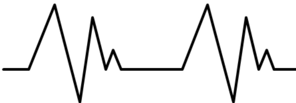
Figura 2.8 Cierre prematuro de la válvula de subsuelo mientras el controlador de superficie permanece abierto
