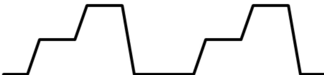
Figura 2.9 Tiempo de inyección de gas del controlador de superficie muy corto
