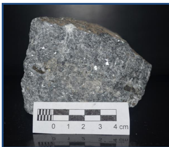
Figura # 46. Muestra BO-GU-CH-3.5 Sur. Color gris azulado claro a medio y brillo perlino. Representada por dolomita, tremolita, diópsido cloritizado y flogopita.
