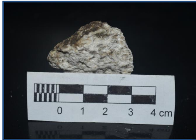
Figura # 24. Muestra Bo-Gu-CH-R1 con textura fanerítica, equigranular, compuesta principalmente de 3 minerales (cuarzo, microclino y biotita).
