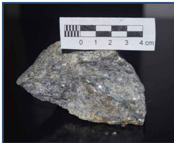
Figura # 42. Muestra BO-GU-CH-3.5 Norte. Constituida principalmente por cristales de dolomita, olivino serpentinizado y diópsido. Los cristales de dolomita son de color gris claro con hábito romboédrico, equigranulares.
