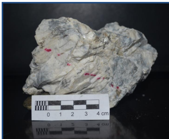
Figura # 18. Muestra Bo-Gu-CH-2.2 presenta textura fanerítica con cristales mayores a 1 cm de longitud.
