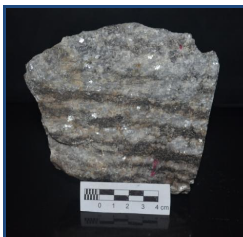
Figura # 66. Muestra C-1. Obsérvese el bandeamiento en la roca diferenciable claramente.
