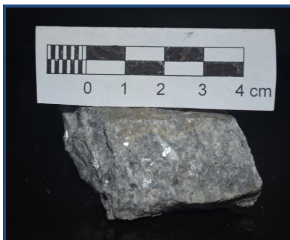
Figura # 35. Muestra BO-GU-CH-2.1. Cristales de dolomita de color gris claro con hábito romboédrico, equigranulares, con tamaño promedio de 2 mm.
