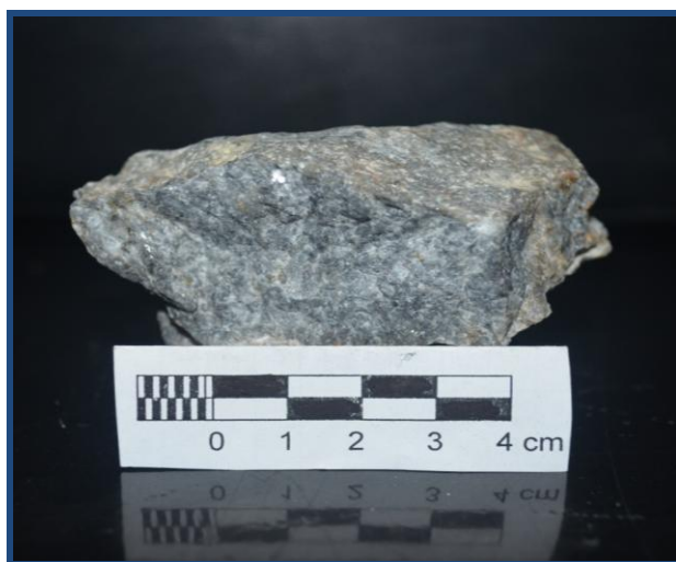
Figura # 38. Muestra Bo-Gu-CH-2.6. Representada por dolomita, diópsido, monticelita, clorita y flogopita. La mayoría de los cristales de dolomita son de 1 mm.
