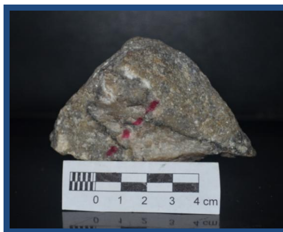
Figura # 15. Muestra de mano Bo-Gu-CH-1.2A con aspecto granular de color gris constituida por dolomita y olivino.
