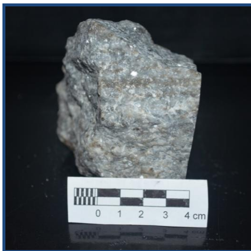
Figura # 58. Muestra Bo-Gu-AB-2.3. Constituida por dolomita, diópsido, olivino serpentizado, monticelita y posible condrodita.
