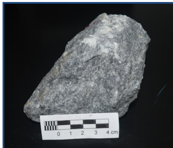
Figura # 12. Muestra de mano BG-CH-3.4 con aspecto granular, masiva de color gris azulado claro a medio y brillo perlino, constituida por dolomita y olivino.
