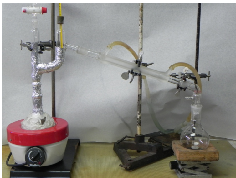
Figura 8. Montaje de la destilación por arrastre con vapor
