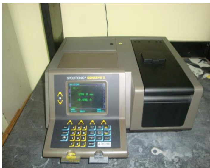
Figura 8. Espectrofotómetro. Modelo Spectronic Genesys 2
