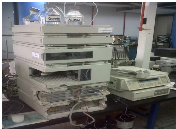
Figura 21-. Cromatógrafo de alta eficiencia, HPLC con detector UV y FL.
