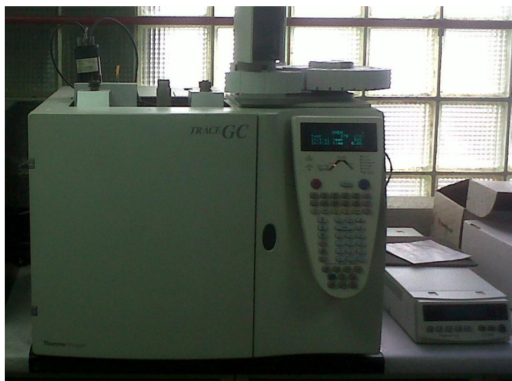
Figura 36-. Cromatografo de Gases, GC con detector FID, Thermo.TraceGC.
