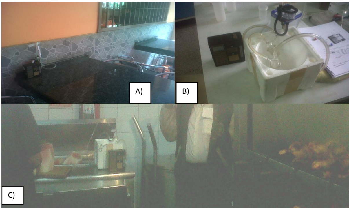
Figura 18-. A) Muestreo externo (Outdoor) XAD-2, B) Sistema extracción gas – Líquido (Burbujeador), C) Muestreo de área por burbujeador, (Indoor) de la cocina del local (a 100cm de la Brasa).
