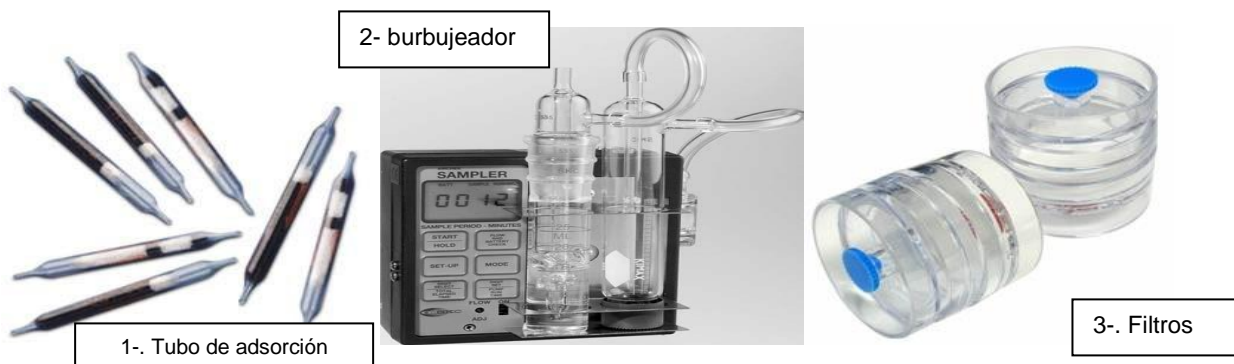
Figura 10 -. Sistema de Muestreo Personal del Aire por: 1) Tubos de adsorción, 2) Burbujeadores, 3) Filtro PTFE con Cassette. (5)
