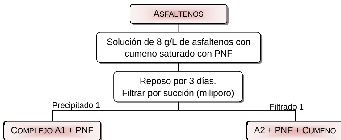
Figura 14. Diagrama de flujo del procedimiento para el fraccionamiento de los asfaltenos.
