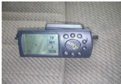
Figura N° 13 GPS Garmin, Plus S (Error + 20 m).
