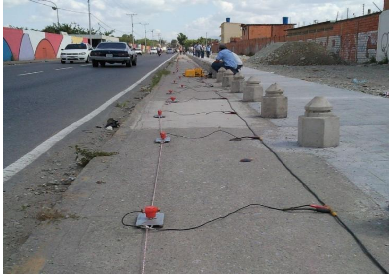
Figura N° 19 Geófonos adaptados a placas de metal o streamers.
