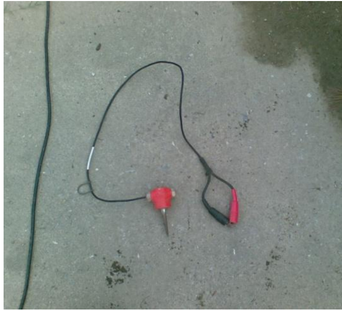
Figura N° 17 Geofono de 4.5Hz con punta o spike.
