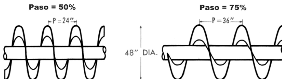
Figura 4.5. Pasos Aviables para los Espirales. Fuente: Catálogo de Clasificadores WEMCO
