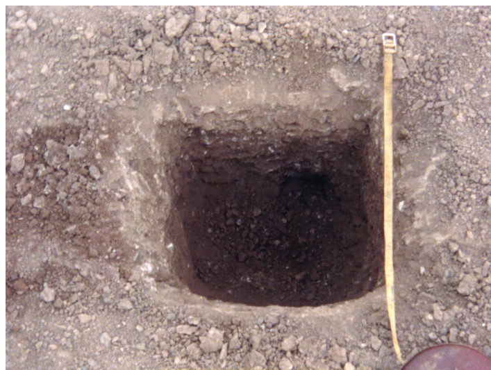
Figura 5.3. Calicata Realizada para la Toma de Muestra.
