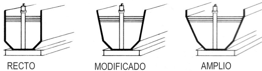
Figura 4.10. Secciones Estándar del Estanque. Fuente: Catálogo de Clasificadores WEMCO
