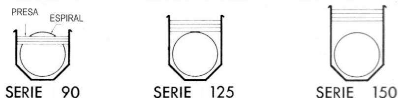
Figura 4.9. Profundidades Estándar del Estanque. Fuente: Catálogo de Clasificadores WEMCO
