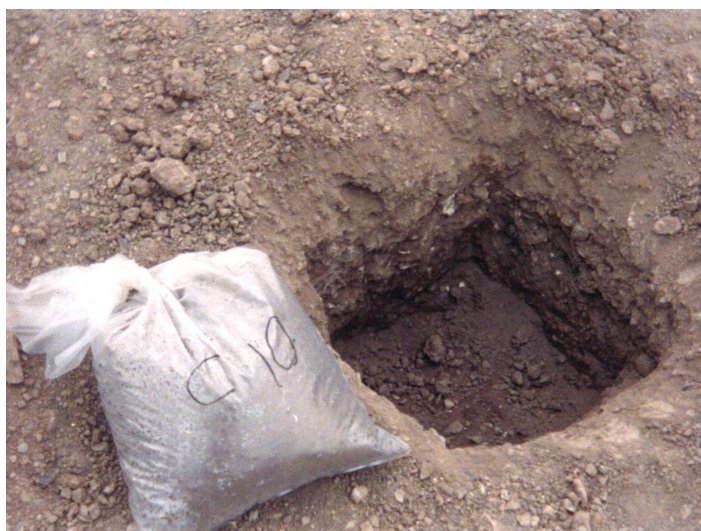
Figura 5.5. Muestra Empacada e Identificada de una Calicata.
