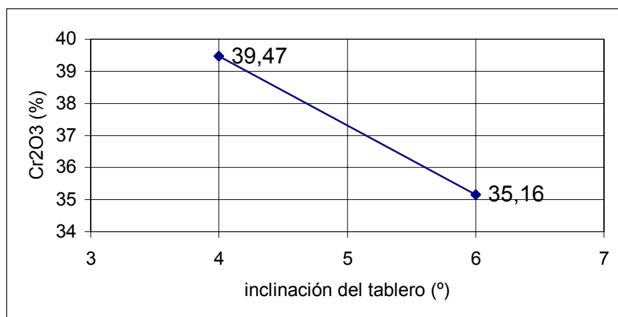
Figura 63. Influencia de la inclinación del tablero sobre el %Cr 2 O 3 en el concentrado.
