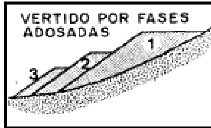
Fig. 9: Método constructivo de escombreras mediante fases adosadas Fuente: ITGE, 1999.
