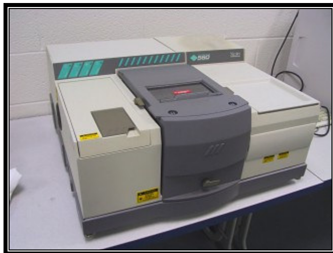
Figura 3.3: Equipo de espectroscopía infrarroja (FT-IR Marca Nicolet, mod. Magna 560) [12]
