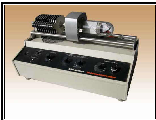
Figura 3.1: Equipo de análisis termogravimétrico (951 Thermogravimetric Analyzer) [10]
