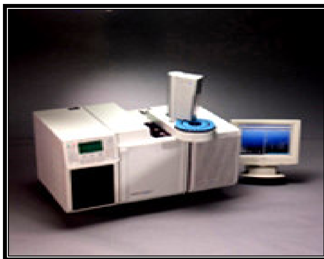
Figura 3.4: Equipo de Cromatografía de gases con detector de masas (CG-EM) [11]
