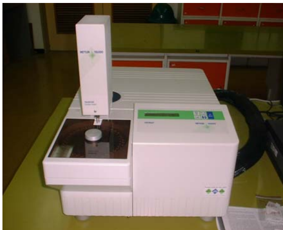
Figura 11. Calorímetro diferencial de barrido DSC 822 e Mettler Toledo. Laboratorio de Polímeros. IVIC.
