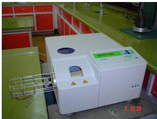
Figura 12. Equipo TGA/SDTA 851 e Mettler Toledo. Laboratorio de Polímeros. IVIC.
