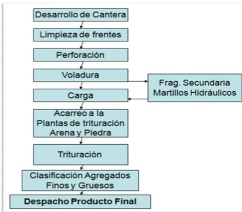
Figura. 43. Descripción del proceso minero en la cantera. Tomado de: Plan de explotación CDC (2015).
