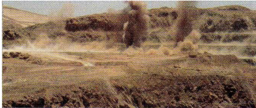
Figura. 15. Voladura a cielo abierto. Fuente: Portal Minero MGMM (2006).
