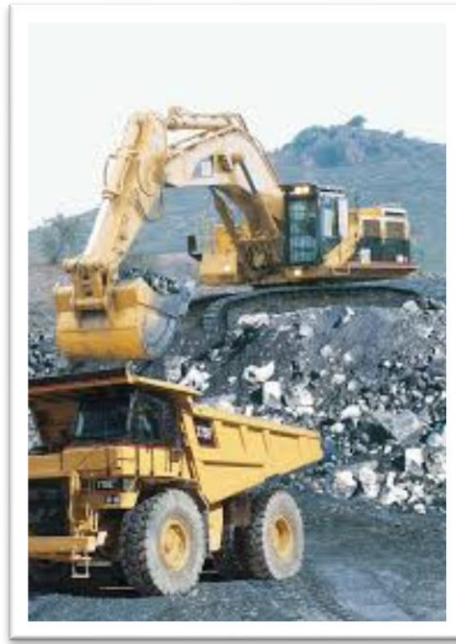
Figura. 21. Posicionamiento de carga, Pala retro. Fuente: Propia (1996).
