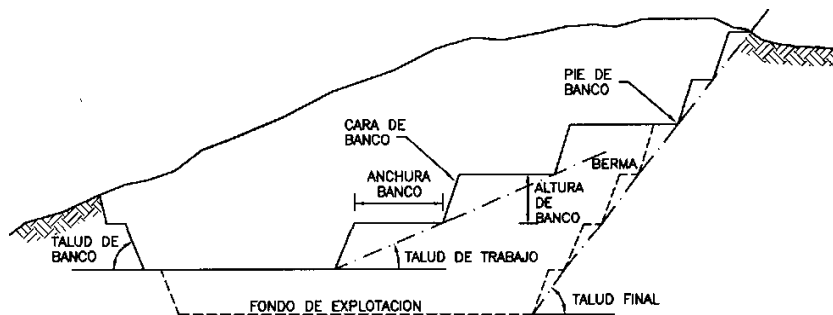
Figura. 13. Parámetros de diseño de una fosa minera. Fuente: ITGE (1996).
