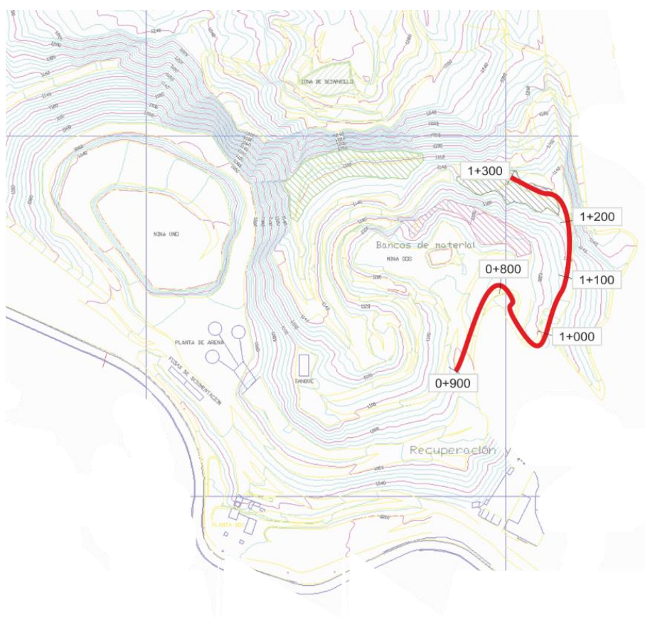
Figura. 55. Trazado de vialidad y progresivas (Tramo 02). Fuente: Propia (2015).
