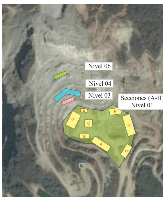
Figura. 68. Secciones de volúmenes de material en bancos. Fuente: Propia (2015).
