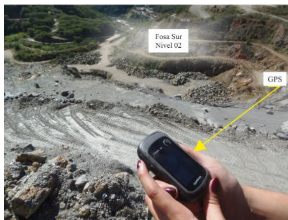
Figura. 50. Levantamiento mediante el uso de GPS. Fuente: Acosta (2015).
