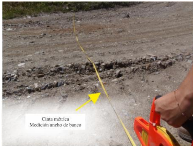
Figura. 51. Medición de ancho de calzada. Fuente: Acosta (2015).
