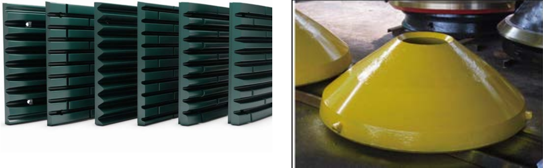
Figura 20. a) revestimiento de trituradora de mandíbula, b): Manto del triturador de cono. Tomado de: https://www.google.co.ve/imgres?imgurl=http%3A%2F%2Fwww.mshchile.cl
